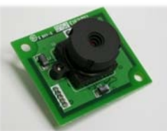
基板寸法 31 mm × 27 mm 装着レンズ NHE28_R
